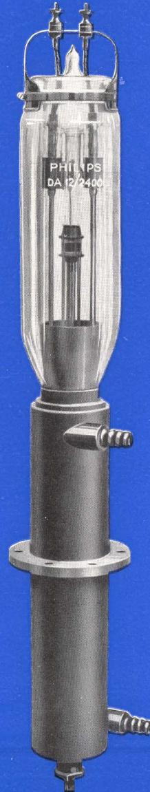
Die Anode dieser wassergekühlten Gleichrichterröhre bildet einen Teil der Aussenwand. Eine unbedingt luftdichte Chromeisenlegierung gewährleistet eine zuverlässige, dauerhafte Verbindung mit dem Glas.
